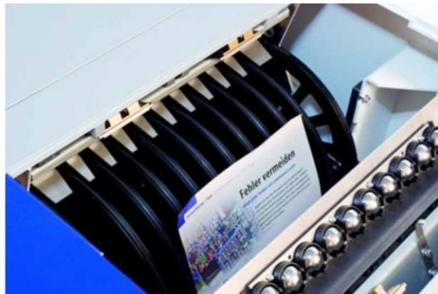
Direktno provođenje papira bez savijanja (bypass)
